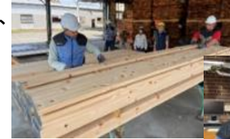
パシフィック木材検査機関(PLIB)による試験材の等級判定
